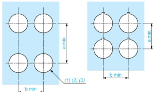
(1) Durchmesser auf fertiger Schalttafel oder Montagehalterung
