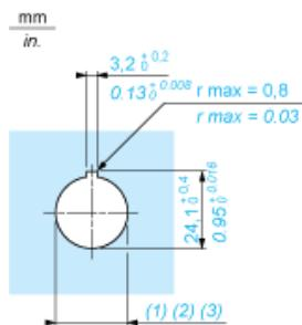
(1) Durchmesser auf fertiger Schalttafel oder Montagehalterung
