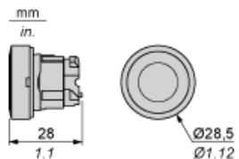
Schaltaffausschnitte für Drucktaster, Schalter und Meldeleuchten (fertige Bohrungen, installationsbereit)
