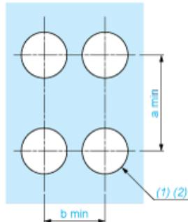
(1) Durchmesser auf fertiger Schalttafel oder Montagehalterung
