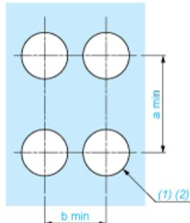
(1) Durchmesser auf fertiger Schalttafel oder Montagehalterung
